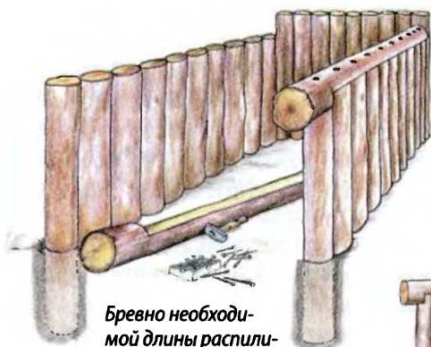
Вертикально стоящие брёвна, которые закапываются в глубину на 1 м и выравниваются до одинаковой высоты.
