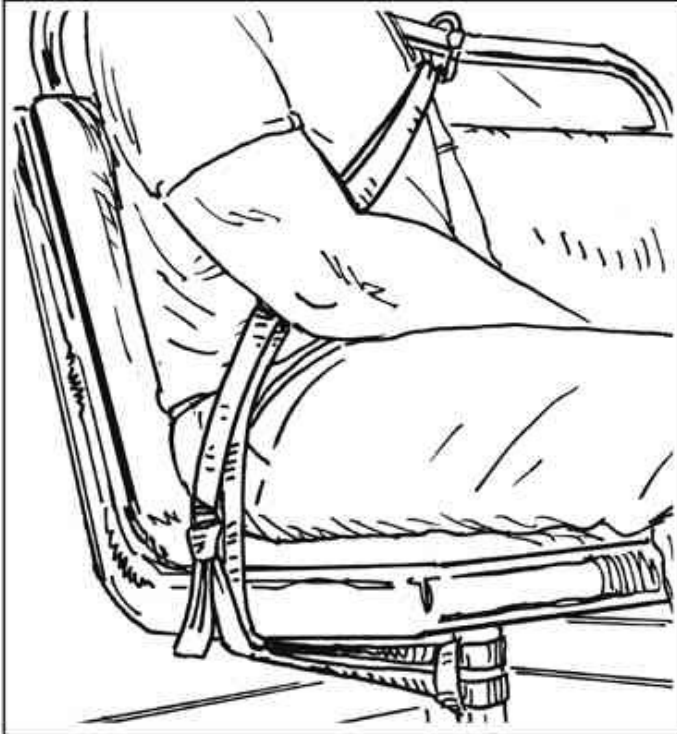
ПД 5: две точки крепления (нагрудный ремень)
