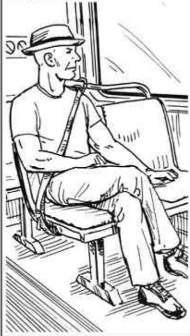
ПД 5: две точки крепления (нагрудный ремень)
