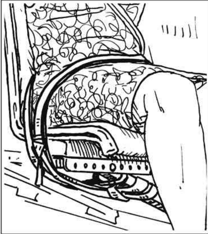
ПД 4: одиночная точка крепления (бедренный ремень безопасности)
